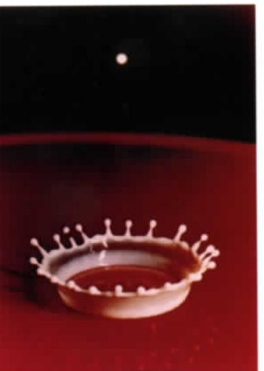
La fotografía Corona de una gota de leche (1957), de Harold Edgerton, se realizó con una luz estroboscópica que es lo bastante intensa y rápida para captar la acción.
